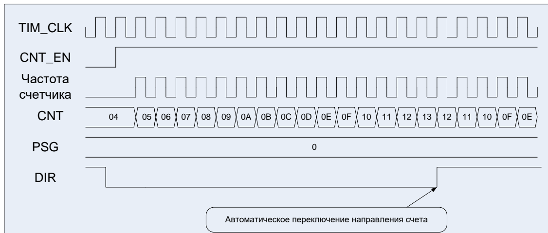
Рисунок 64 – Диаграммы работы таймера, счет двунаправленный, сначала прямой
